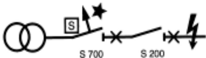
Selektivität besteht bis zu den angegebenen Kurzschlussströmen in kA
